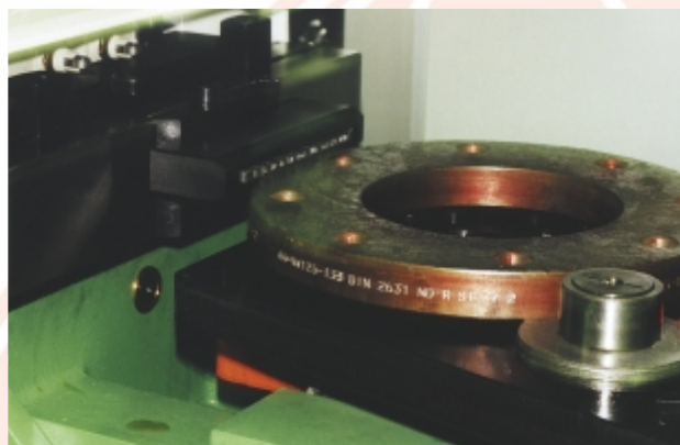
Маркировка фланцев на MB 76EP90°
