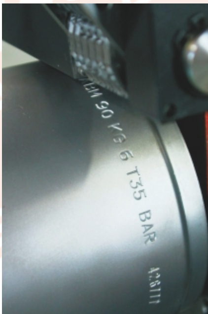
Процесс маркировки корпуса огнетушителя на аппарате MB 76EP
