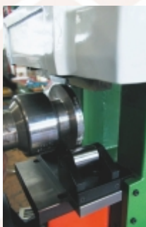
Процесс маркировки корпуса клапана высокого давления на аппарате MB 71EP
