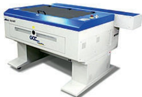
Гравер-раскройщик MG380 Hybrid оснащен одновременно двумя типами лазерных источников: металлической лазерной трубой Synrad (США) и стеклянной лазерной трубой Rici (Китай).
