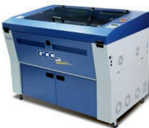
Серия лазерных гравировальных машин Spirit GX представляет собой обновленную модификацию модели LaserPro Spirit SG. Максимально возможное рабочее поле станка составляет 965 x 610 мм: лазерный гравер с рабочим полем раскройщика! Конструкция портала DuraGuide исключает наличие роликов каретки. Кроме того, портал оснащен кевларовыми ремнями, обеспечивающими высокую прочность узла, долговечность и стабильность работы.
